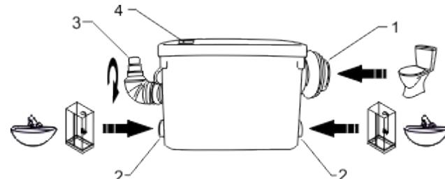
Бытовая канализационная насосная станция SANIVORT 400A предназначена для перекачивания сточных вод, содержащих фекалии.
