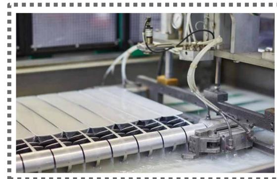
Автоматизированные револьверные линии по обработке и сборке алюминиевых и биметаллических радиаторов всех типов, в том числе и дизайнерских со сложными выпукло-вогнутыми формами **Gi-Zeta Impianti** (Италия).
