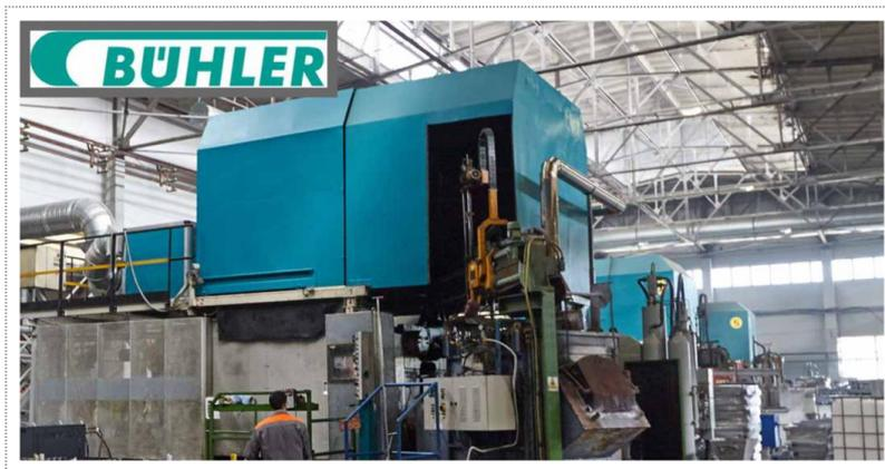
РОБОТИЗИРОВАННЫЕ КОМПЛЕКСЫ ЛИТЬЯ ПОД ДАВЛЕНИЕМ С УСИЛИЕМ ЗАПИРАНИЯ ДО 2000 ТОНН:
