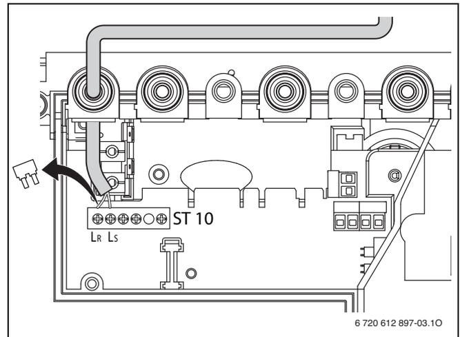
Рис. 17 Подключение (230 В AC, снять перемычку между L<sub>S</sub> и L<sub>R</sub>)
