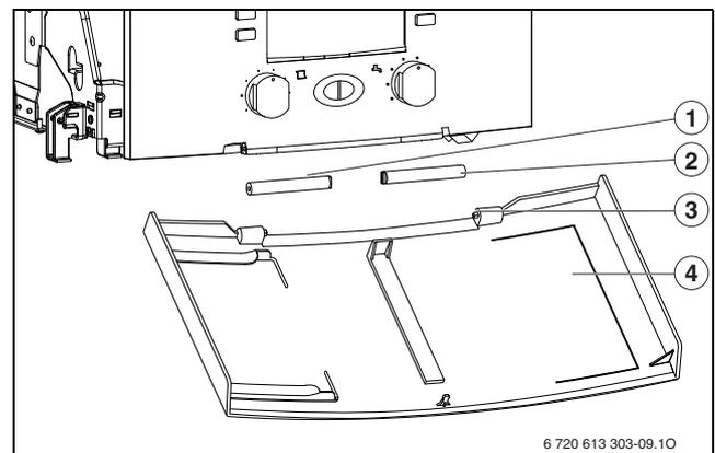
Рис. 10 Монтаж крышки
