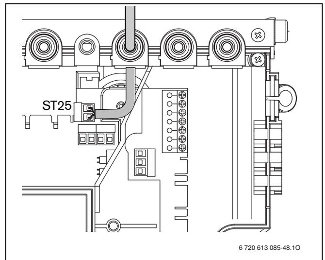
Рис. 23 Подключение циркуляционного насоса
