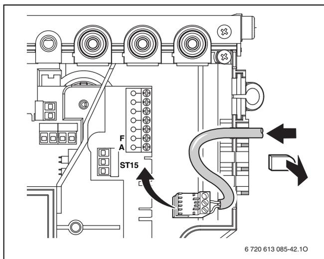
Рис. 21 Разъем для подключения датчика температуры бойлера (NTC)
