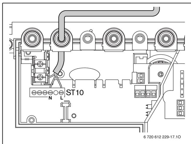
Рис. 24 Клеммная колодка для подачи питания ST10
