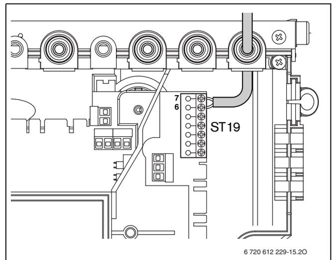
Рис. 18 Подключение регулятора
