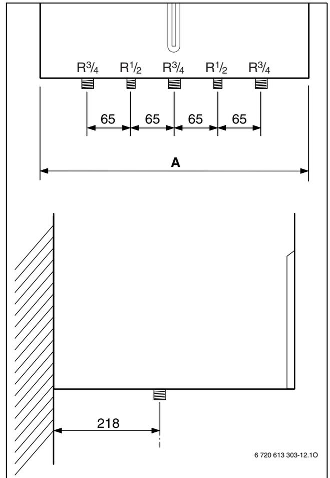
Рис. 13 Размеры расположения соединений
