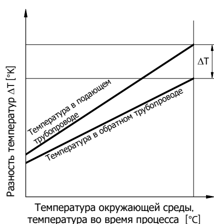
График перепада температур в зависимости от температуры процесса или температуры окружающей среды
