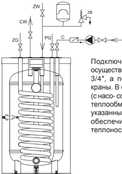
Подключение к отопительной системе следует осуществлять при помощи соединительных патрубков  $3/4"$ , а перед патрубками установить отсечные краны. В системах с принудительной циркуляцией (с насосом в отопительной системе), для того, чтобы теплообменник имел параметры производительности указанные в пункте „Технические данные”, следует обеспечить соответствующий уровень протока теплоносителя.
