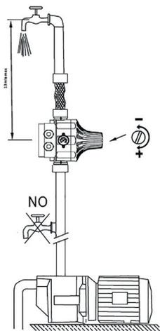
7.1. Блок автоматики устанавливается между насосом и первой точкой водоразбора. Блок оснащен обратным клапаном. Рекомендуется подключать выход блока к системе водоснабжения с помощью гибкой подводки (смотреть рисунок). Направление потока жидкости должен совпадать со стрелкой на корпусе.
