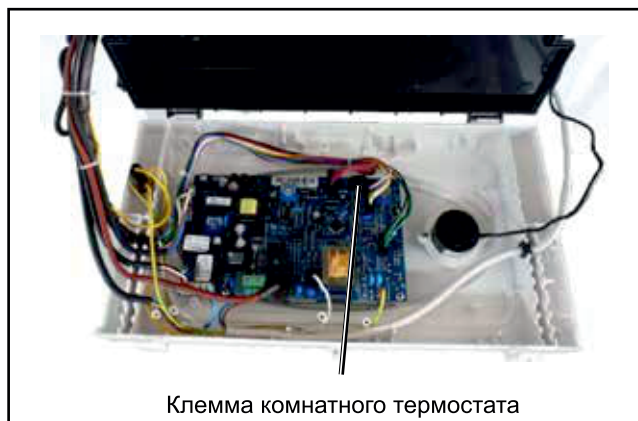
Рис. Подключение комнатного термостата
