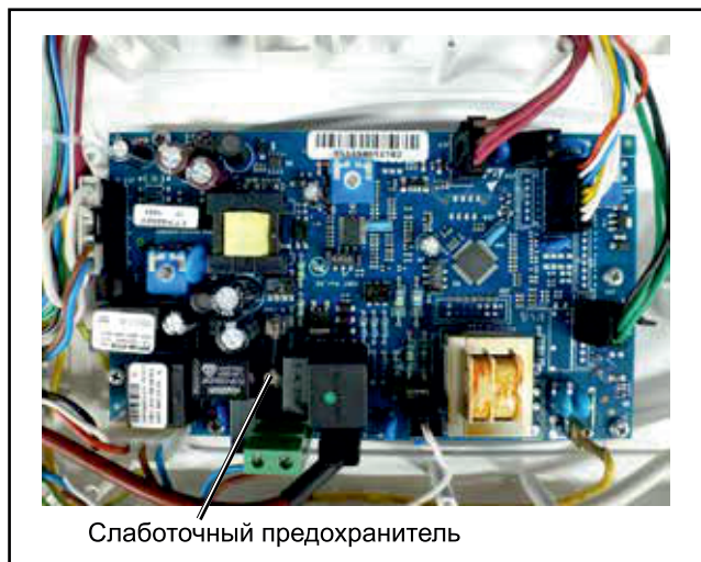
Рис. Замена предохранителей
