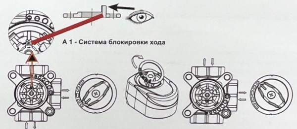
Схема настройки трехходового клапана в качестве смесительной арматуры
