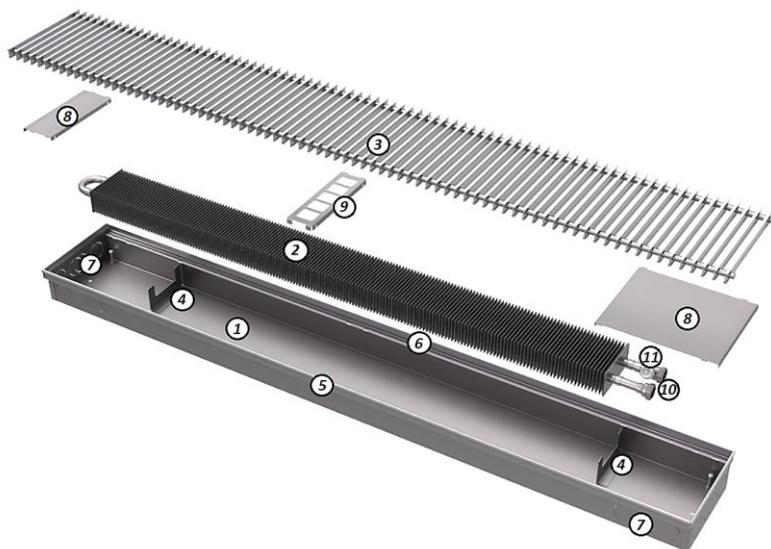
**1. Корпус конвектора** из стали, окрашенный порошковой краской в полном объеме, оснащенный перфорацией для возможности подключения трубопроводов с разных сторон конвектора.
