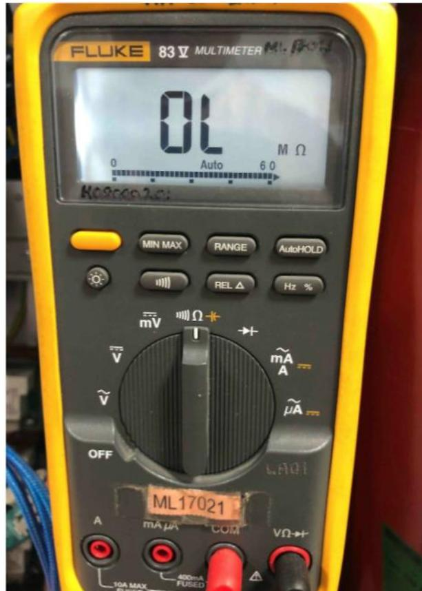
g- Если лампы горят и все еще отображается "OL", то есть цепь разомкнута, замените плату реле.
