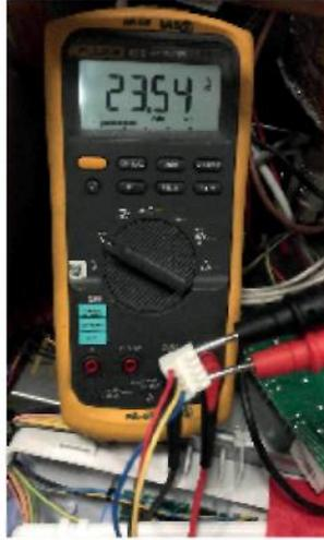
Измерение контактов реле
