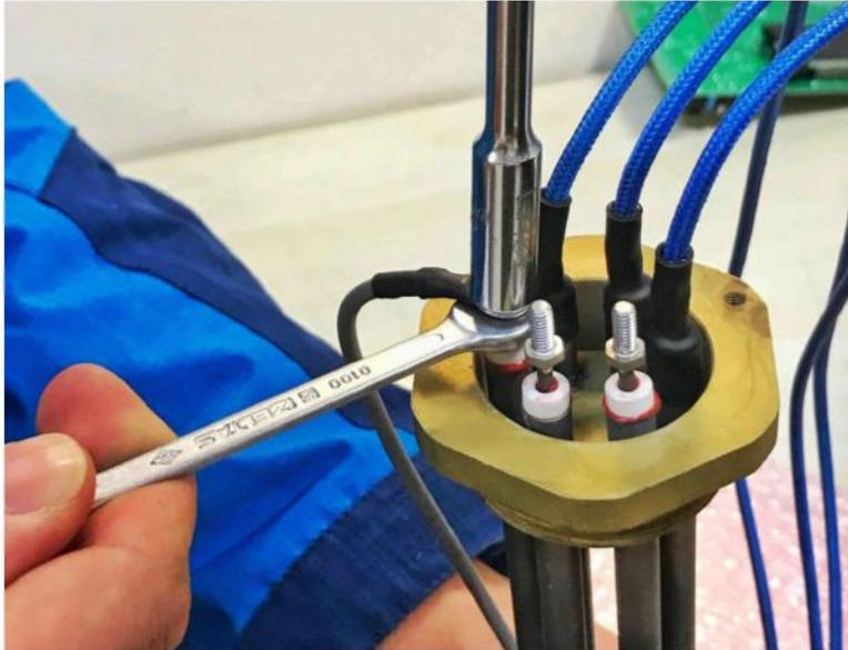
При затягивании фазных проводов необходимо установить шайбу М4, кольцевую клемму, пружинную шайбу М4 и гайку М4 соответственно. Поворачивая гайку с гнездом с верхней стороны, клемму резистора следует зафиксировать ключом на 1/4 дюйма с нижней стороны.
