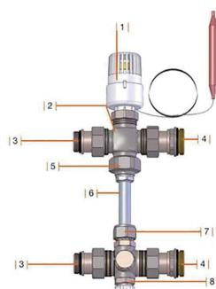
1. Термостатическая головка с капиллярным датчиком
